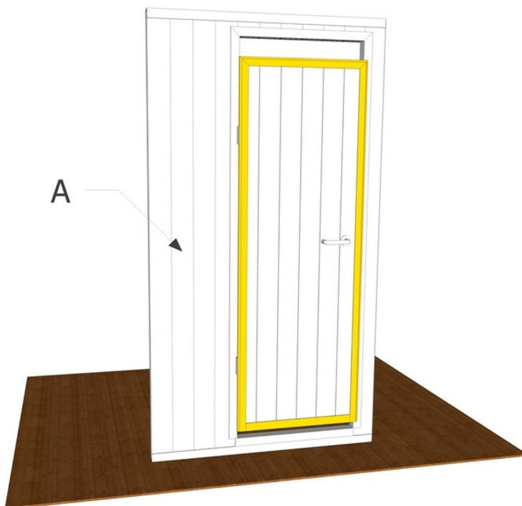
Prenez les croix, en faisant attention à placer les plus longues à l'avant et les plus courtes à l'arrière. Rapprocher la paroi de gauche (paroi B) de la paroi A et insérer l'encastrement de haut en bas
