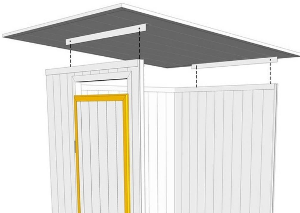
Percer les trous traversants sur les profilés en L et le mur pour
