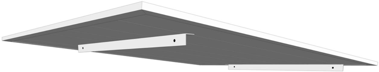
Posizionare il tetto sulla cabina, facendo in modo che i profili a L rimangano all'interno delle 4 pareti.
