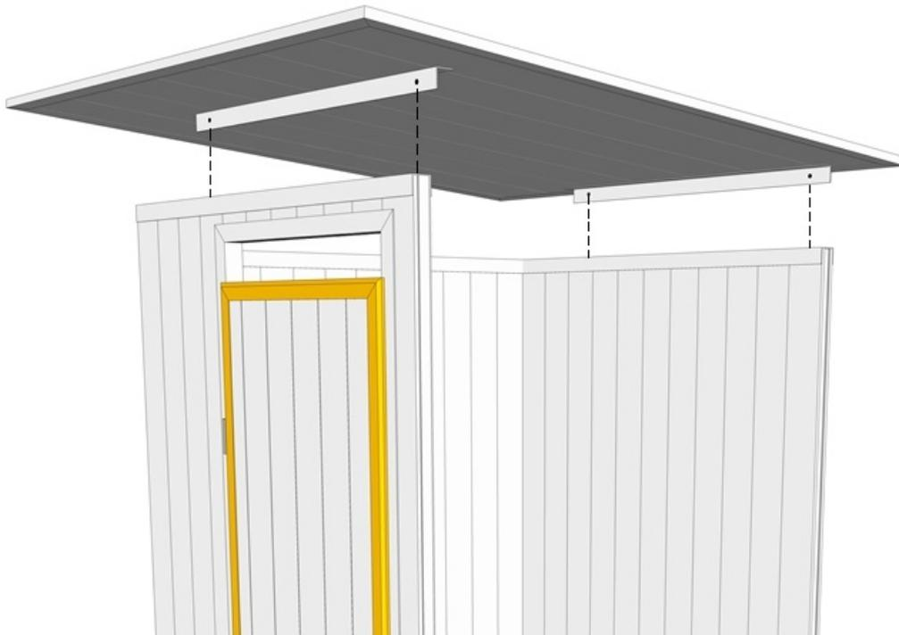
Praticare i fori passanti sui profili ad L e sulla parete per ancorare il tetto alla struttura mediante i bulloni in acciaio inox
